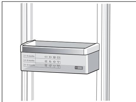
Aby nedošlo ke snížení kvality mražených potravin, nepřekračujte doporučenou dobu skladování. Doba skladování závisí na druhu výrobku. Číslice vedle symbolů poukazují na povolenou dobu skladování potravin v měsících. V případě komerčně dostupných potravin dodržujte datum spotřeby určené výrobcem.
