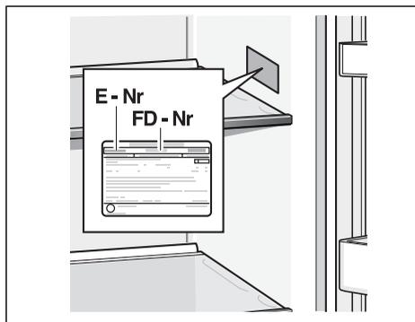
Pre zabránenie zbytočných výjazdov uveďte pri telefónnom hovore označenie produktu a výrobné číslo. Ušetríte tak dodatočné poplatky.
