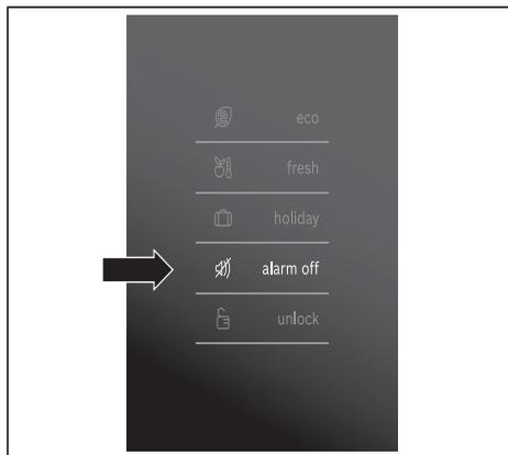
Nastavená teplota mrazicího prostoru bliká na displeji. Zobrazí se "alarm off" a rozsvítí se červený ukazatel dveří.
