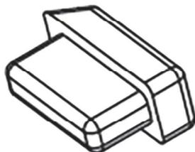
Neodstraňujte tyto gumové tlumicí bloky ze dveří. Pokud by na některých dveřích tento blok chyběl – nahradte ho novým (je součástí drobného příslušenství v sáčku spolu s návodem k použití).
