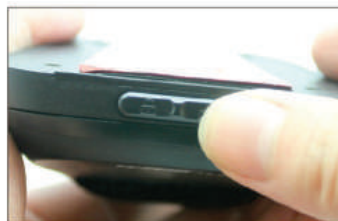
3. Den Riegel nach links drücken
