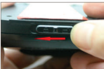
3. Den Riegel nach links drücken
