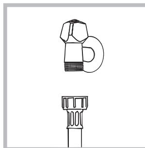
1. A vízbevezető cső csatlakoztatásához csavarozza fel a csövet egy 3/4"-os külső menettel rendelkező hidegvízcsapra (lásd ábra). A csatlakoztatás előtt eressze meg a csapot, és folyassa a vizet addig, amíg az teljesen átlátszóvá nem válik!
