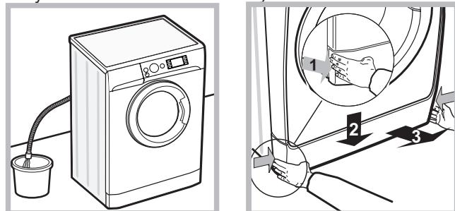
2. Zkontrolujte, zda je hladina vody uvnitř zařízení nižší, než je úroveň otevření dvířek; v opačném případě vypustěte přebytečnou vodu vypouštěcí hadici a zachytěte ji do vědra, jak je znázorněno na obrázku.
