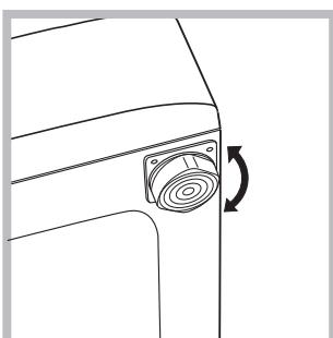
2. V případě, že podlaha není dokonale vodorovná, mohou být případné rozdíly vykompenzovány šroubováním předních nožek (viz obrázek); Úhel sklonu, naměřený na pracovní ploše, nesmí přesáhnout 2°.
