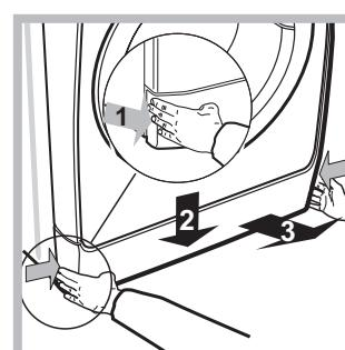
1. Çıkarana kadar ilk önce ortaya doğru bastırarak ve her iki yanından iterek makinenin önündeki kapak panelini çıkarın (*şekile bakınız*);
