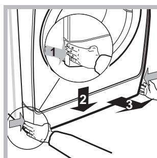
1. Sejměte krycí panel na přední straně zařízení zatlačením na jeho střed a následným zatlačením směrem dolů z obou stran a poté jej vytáhněte (viz obrázky).
