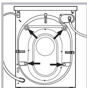
3. Koruyucu 4 vidayı (nakliye sırasında kullanılır) ve cihazın arka kısmına yerleştirilen ilgili ara parça ile birlikte lastik contayı çıkarın (şekle bakınız).
