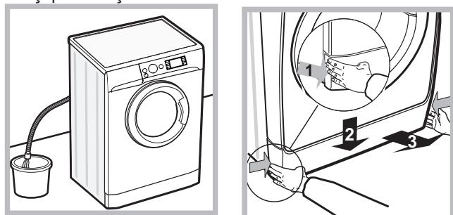
2. makinenin içindeki su seviyesinin makine kapağından daha alçak olmasını sağlayınız, aksi takdirde A şeklärde gösterildiği gibi bir kaptı toplanacak şekilde boşaltma hortumu vasıtasyyla içindeki suyu gideriniz.
