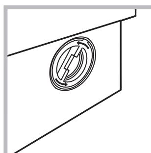
2. Odšroubujte víko jeho otáčením proti směru hodinových ručiček (viz obrázek): vytečení malého množství vody je zcela běžným jevem;
