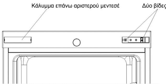
7) Τοποθετήστε το κάλυμμα του επάνω αριστερού μεντεσέ στην δεξιά πλευρά και αφαιρέστε τις δύο βίδες
