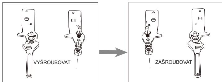
6. Instalujte konzoly na spodní závěs. Vraťte zpět obě nastavitelné nožky
