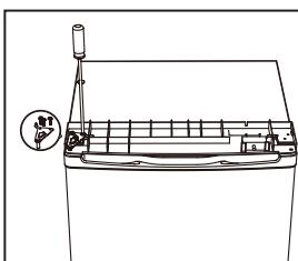
9. Załącz górną pokrywę i zabezpiecz ją 2 śrubami z tyłu.
