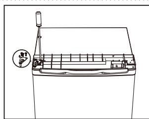
9. Nasadte horní kryt a upevněte jej pomocí 2 šroubů na zadní straně.
