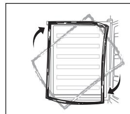
8. Umieścić drzwi urządzenia na miejscu. Przed ostatecznym dokręceniem śrub, decyduje o tym, czy drzwi pasują poziomo czy pionowo i czy uszczelka jest dobrze dopasowana ze wszystkich stron.
