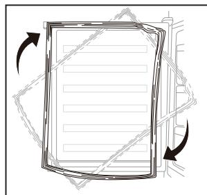
8. Helyezze vissza az ajtót! Mielőtt teljesen rögzíti a csavarokat, ellenőrizze az ajtó függőleges és vízszintes oldalát és a tömítés megfelelő működését!
