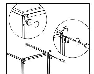
5. Odkręć i wyjmij dolny sworzeń zawiasu, odwróć wspornik i wymień go.
