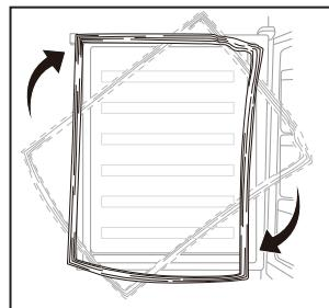
8. Vráťte dvere späť. Než definitívne dotiahnete skrutky, skontrolujte, či dvere horizontálne aj vertikálne doliehajú a či tesnenie po všetkých stranách správne dosadá.
