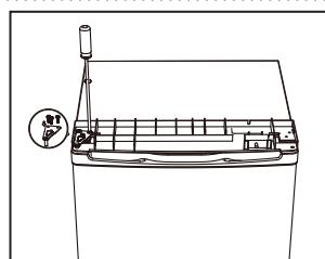
9. Nasadte horný kryt a upevnite ho pomocou 2 skrutiek na zadnej strane.
