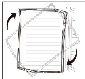
8. Vraťte dveře zpět. Než definitivně dotáhnete šrouby, zkontrolujte, zda dveře horizontálně i vertikálně lícují a zda těsnění po všech stranách správně dosedá.
