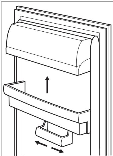
Ten model urządzenia wyposażono w regulowany pojemnik, który można przesuwać na boki.
