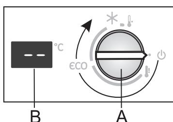
**Zapnutí:** Pro zapnutí otočte spínačem A po směru hodinových ručiček.
