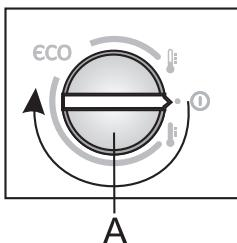
**Zapnutí:** Pro zapnutí otočte spínačem **A** po směru hodinových ručiček.
