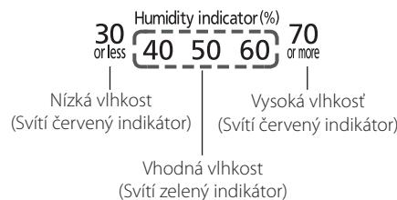
(Tento indikátor zobrazuje pouze vlhkost a vlhkost nelze nastavit.)
