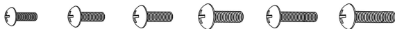
M4x14 (x2) A M5x14 (x2) B M6x14 (x4) C M8x20 (x2) D M6x30 (x4) E M8x30 (x4) F
