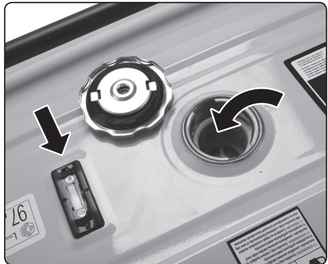
13. ábra. A tartályban lévő üzemanyag mennyiségét mutató kijelző és az üzemanyag szűrőszita
