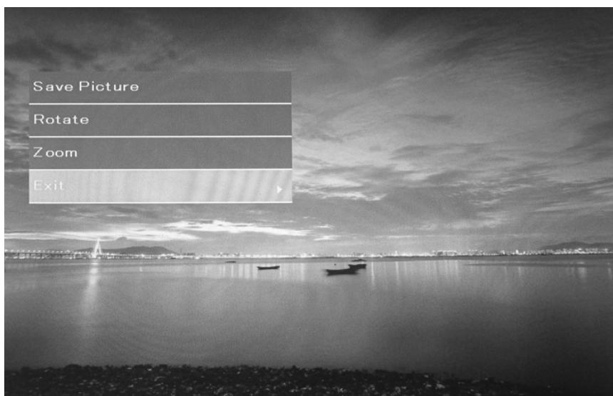
Válassza ki a Save picture (kép mentése) opciót, utána nyomja meg a ▷|| gombot a kiválasztott kép beépített memóriába való mentéséhez! A készülék 8M beépített memóriával rendelkezik, amelybe maximum 5, 480\*234 felbontású képet lehet menteni. A maximális támogatott JPEG fájl mérete 64M (8000\*8000).
