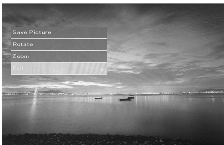
Wybrać funkcję „Zapisz obraz”, a następnie nacisnąć przycisk **▷||**, żeby zapisać zdjęcie we wbudowanej pamięci urządzenia. W ramce, zawierającej pamięć o pojemności 8M można zapisać maksymalnie 5 zdjęć o rozdzielczości 480\*234, urządzenie obsługuje pliki JPEG o maksymalnym rozmiarze 64M (8000\*8000).
