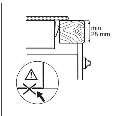
**i** Jeśli urządzenie jest zainstalowane nad szufladą, wentylator płyty grzejnej może spowodować nagrzewanie przedmiotów w szufladzie podczas procesu gotowania.
