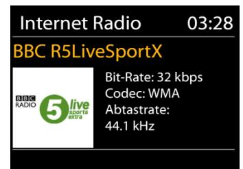
Lorsque vous sélectionnez la radio internet, l'appareil contacte directement le portail de radio internet Frontier Silicon (pris en charge par v-tuner) pour obtenir une liste de stations.
