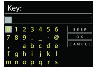
Otočením navigačného kolieska dozadu pred prvými znakmi sú k dispozícii tri možnosti – „Backspace“, „OK“ a „Cancel“.
