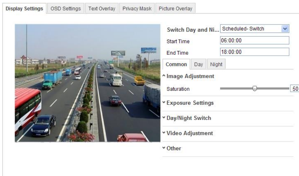
Figure 5-37 Rozhraní konfigurace plánovaného přepínání dne/noci
