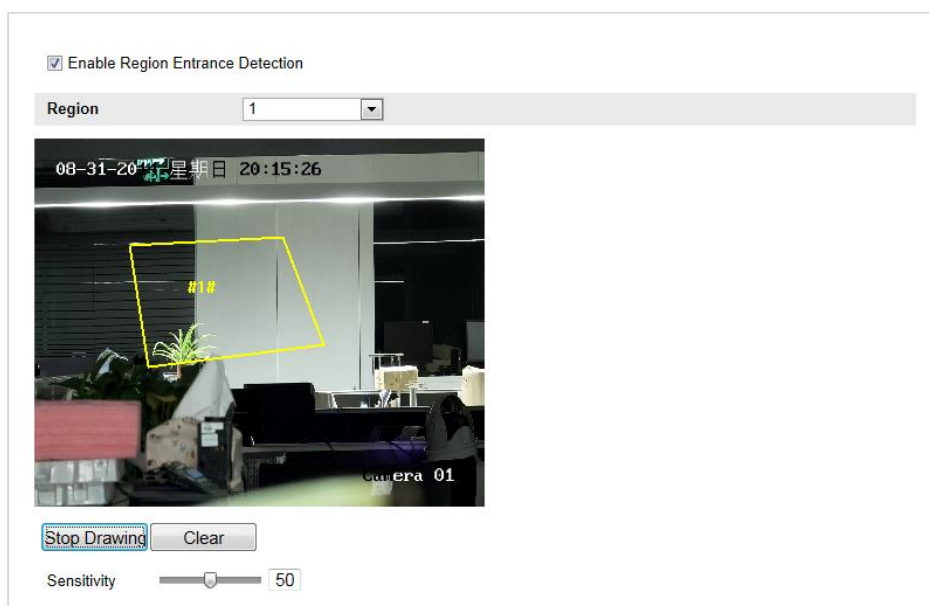
Figure 5-64 Konfigurace detekce vstupu do oblasti
