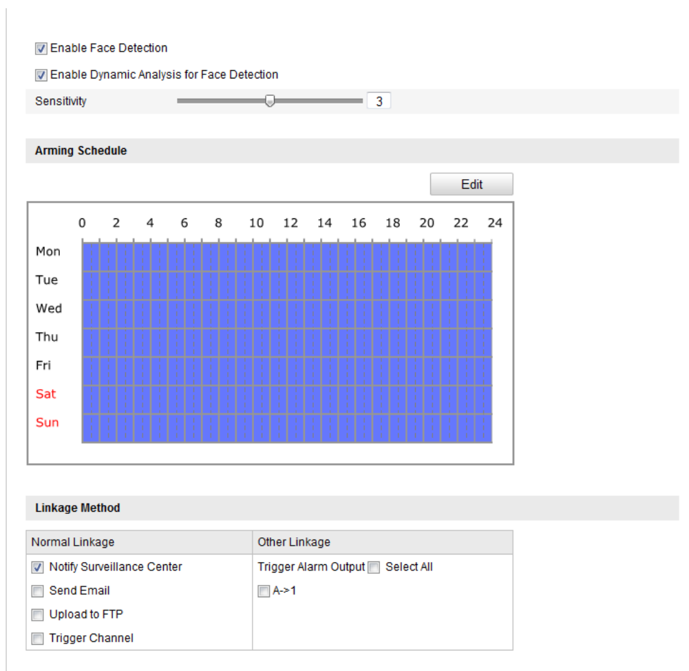
Figure 5-61 Konfigurace detekce obličeje
