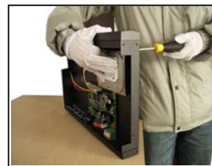
③ Vložte šroub pevného disku
