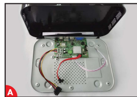
Odpojte NVR od napájania, vyskrutkujte skrutky a zložte horný kryt.
