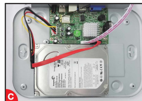
Umiestnite disk HDD do rekordéru podľa plôch pre uchytenie. Kabeláž umiestnite okolo disku HDD.
