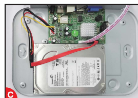
C Umístěte disk HDD do rekordéru dle ploch pro uchycení. Kabeláž umístěte kolem disku HDD.
