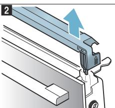
**Upozornění:** Ocelovou vkládací drážku v krytu dvířek vycistěte čisticím přípravkem na nerezovou ocel. Ostatní části krytu dvířek očistěte jemným hadříkem a mydlovou vodou.
