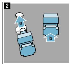
3. Držiak vzadu zasuňte do horného okrúhleho otvoru **a** stlačte ho do dolného otvoru **b** (obr. 3).
