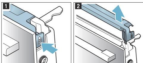
**Upozornenie:** Ocelovú vkladaciu drážku v kryte dverok vyčistite čistiacim prípravkom na nehrdzavejúci ocel. Ostatné časti krytu dverok očistite jemnou handričkou a mydlovou vodou.
