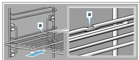
Při vkládání pečících plechů dbejte na to, aby byl zajišťovací výrez vzadu **a** směrem dolů. Zkosení příslušenství **b** musí být vpředu směrem ke dvířkům přístroje.
