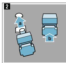
3. Držák vzadu zasuňte do horního kulatého otvoru **a** stlačte jej do dolního otvoru **b** (Obr. 3).
