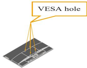
Krok 5: Připevněte monitor LCD na stěnu podle pokynů v sadě stěnového nosiče.
