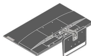
Krok 4: Připevněte montážní konzolu ze sady stěnového nosiče kompatibilní se standardem VESA (vzdálenost 100 mm x 100 mm), VESA montážní šroub M4 x 10 mm.
