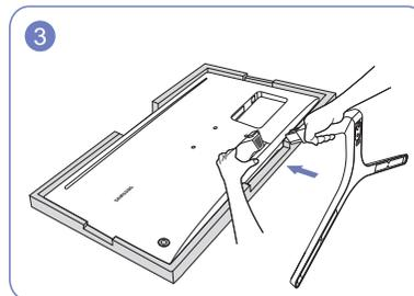
Na podlahu umístěte ochranný prostředek Styrofoam (podložka), který je součástí balení, a umístěte výrobek na prostředek Styrofoam horní částí směrem dolů podle nákresu. Nemáte-li k dispozici prostředek Styrofoam, použijte silnou sedací podložku. Držte zadní stranu monitoru podle obrázku. Zasuňte sestavený stojan do tělesa výrobku ve směru šipky znázorněné na obrázku.
