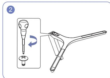
Otočte spojovacím šroubem na spodní straně stojanu nadoraz, aby byl stojan zcela upevněn.
