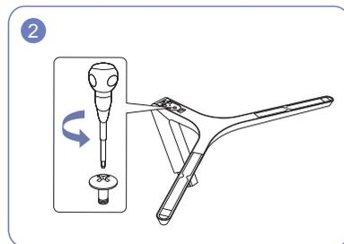
Otočte spojovacím šroubem v dolní části stojanu a stojan oddělte.
