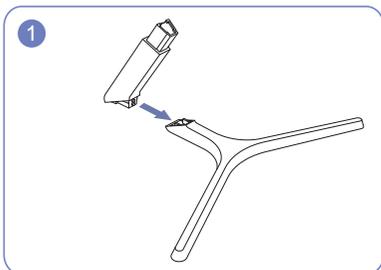
Zapojte konektor stojanu do stojanu ve směru znázorněném na obrázku. Zkontrolujte, zda je konektor stojanu pevně připojen.
