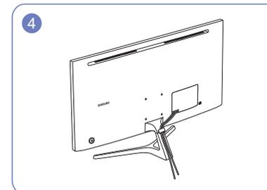
Podle obrázku připojte napájecí a datový kabel.
