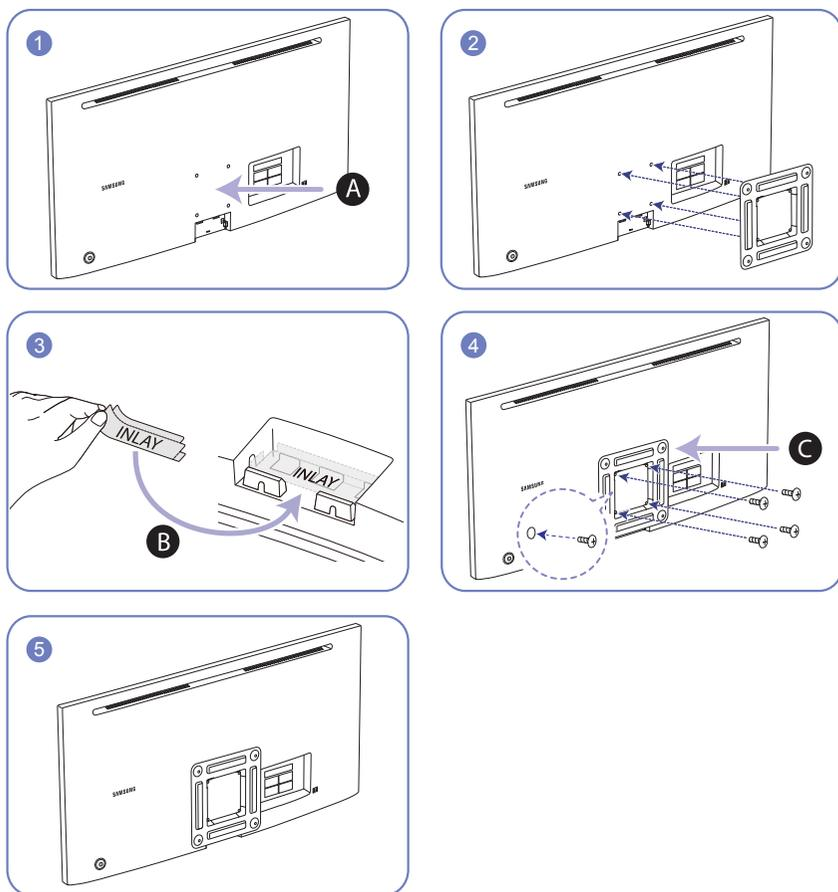
**A** Sem připevněte soupravu pro montáž na stěnu nebo stolní stojan.
