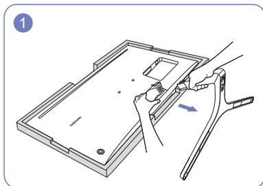
Na podlahu umístěte ochranný prostředek Styrofoam (podložka), který je součástí balení, a umístěte výrobek na prostředek Styrofoam horní částí směrem dolů podle nákresu. Nemáte-li k dispozici prostředek Styrofoam, použijte silnou sedací podložku. Zatímco jednou rukou držíte monitor, vytáhněte druhou rukou konektor stojanu a oddělte stojan podle obrázku.
