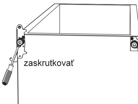
7. Nasadíte znova dvere. Než upevníte horný záves, zaistíte, aby boli dvere horizontálne aj vertikálne v správnej polohe tak, aby tesnenie na všetkých stranách doliehalo.
