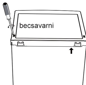
10. Mielőtt véglegesen rögzíti az ajtó csavarjait ellenőrizze az ajtó vízszintes és függőleges pozícióját, illetve a tömítés megfelelő működését!
