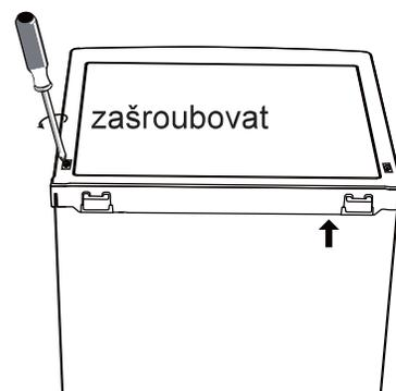
10. Než definitivně dotáhnete šrouby, se zavřenými dveřmi zkontrolujte, zda dveře horizontálně i vertikálně lícují a zda těsnění po všech stranách správně dosedá.
