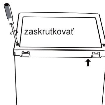
10. Pred definitívnym dotiahnutím skrutiek, so zatvorenými dverami skontrolujte, či dvere horizontálne aj vertikálne lícujú a či tesnenie po všetkých stranách správne dosadá.
