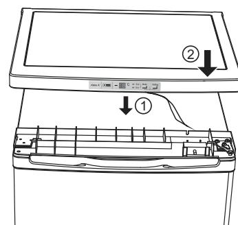
9. Csatlakoztassa a hátsó oldalán lévő 2 csavart!
