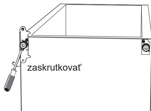
7. Nasadťte znova dvere. Než upevníte horný záves, zaistite, aby boli dvere horizontálne aj vertikálne v správnej polohe tak, aby tesnenie na všetkých stranách doliehalo.
