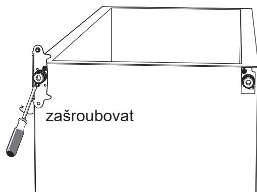
7. Nasaděte znovu dveře. Než upevníte horní závěs, zajistěte, aby byly dveře horizontálně i vertikálně ve správné poloze tak, aby těsnění na všech stranách doléhalo.
