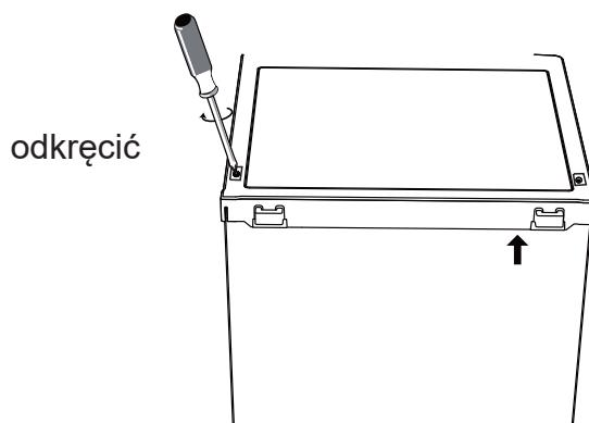
2. Ostrożnie unieść pokrywę o ok. 5 cm ponad urządzenie i wyciągnąć podłączenie panelu. Następnie zdjąć pokrywę.
