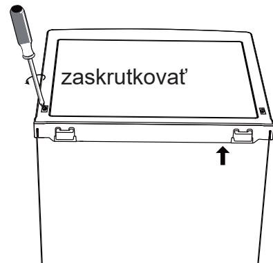
10. Pred definitívnym dotiahnutím skrutiek, so zatvorenými dverami skontrolujte, či dvere horizontálne aj vertikálne lícujú a či tesnenie po všetkých stranach správne dosadá.
