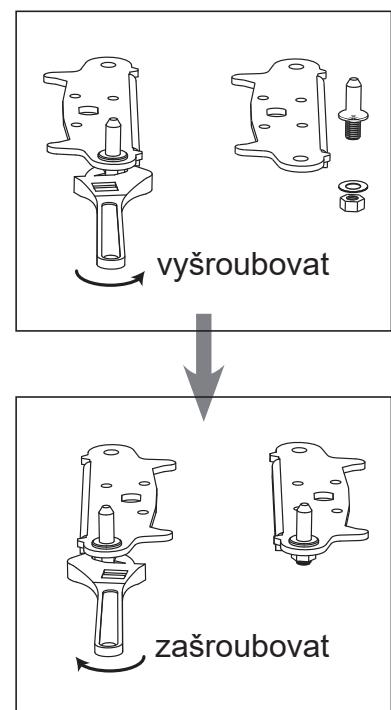
6. Vraťte zpět konzoli na kolík spodního závěsu. Instalujte obě nastavitelné nožky.
