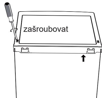
10. Než definitivně dotáhnete šrouby, se zavřenými dveřmi zkontrolujte, zda dveře horizontálně i vertikálně lícují a zda těsnění po všech stranách správně dosedá.
