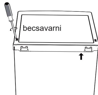
10. Mielőtt teljesen rögzíti a csavarokat, ellenőrizze az ajtó függőleges és vízszintes elhelyezését és a tömítés megfelelő funkcióját!
