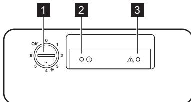
1 Lämpötilan säädin
