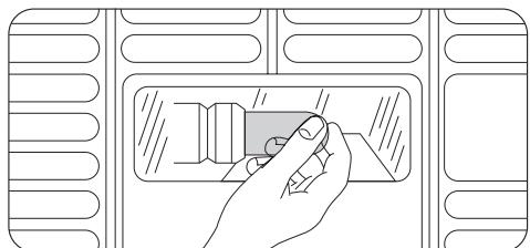
2. Byt lampan mot en med samma effekt som är specialtillverkad för produkten. (max. effekt anges på lampskyddet)
