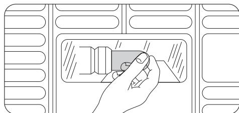
2. Vaihda lamppu saman tehoiseen lamppuun, joka on tarkoitettu erityisesti kodinkoneisiin. (maksimiteho on merkitty lampun suojaan)
