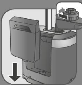
**SV** Skruva tillbaka locket för vattenbehållaren helt och montera tillbaka vattenbehållare i apparaten.
