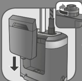
**FI** Kierrä korkki kunnolla kiinni ja aseta säiliö paikalleen laitteeseen.
