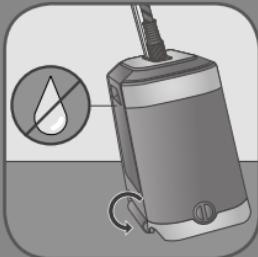
**FR** Assurez-vous que le réservoir d'eau est vide avant de déplacer l'appareil sur sa roue.
