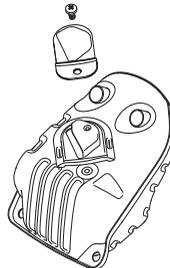
Tłumik przeznaczony jest do tłumienia hałasu i odrzucania gazów spalinowych poza strefę pracy operatora. Gazy spalinowe mają wysoką temperaturę, a znajdujące się w nich iskry mogą spowodować pożar, jeżeli skierowane zostaną w stronę materiałów suchych i łatwopalnych.
