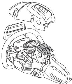
Důkladnějšího vyčištění filtru dosáhnete jeho vypráním ve vodě se saponátem.
