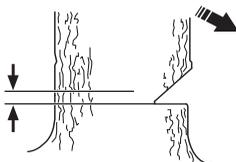
Illeszse be a kéregtámaszt (ha fel van szerelve) a törési léc mögé. Hatoljon a vágószerszeggel óvatosan a fatörzsbe, teljes gázadás mellett. Győződjön meg arról, hogy a fa nem kezd el a tervezett irányval ellentétes irányba mozdulni. Helyezzen a vágásba döntőkeket vagy döntőemelőt, amint a vágás elég mély.
