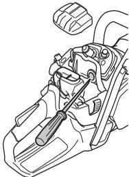
Dla temperatur poniżej -5°C i/lub opadów śniegu wymagane jest zamontowanie na obudowie rozrusznika specjalnej osłony.
