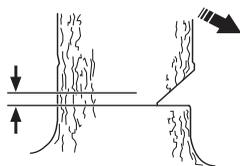
Nasadíte zubovou opěrku (pokud je jí pila vybavena) těsně za "dřevorubecský kloub" (viz dále). Rozběhnete motor na plný plyn a zařezáváte řetěz/lištu pomalu do stromu. Kontrolujte, zda se strom nezačne sklánět opačným směrem, než je zamýšlený směr kácení. Jakmile je řez dostatečně hluboký, zarazte do něj klín nebo páčidlo.
