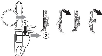
Směrový zářez by měl být veden do hloubky 1/4 průměru kmene a úhel mezi horním a spodním řezem by měl být nejméně 45°.
