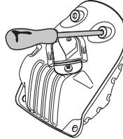
Niektóre typy tłumików są wyposażone w siatkę przeciwwiskrową. Jeżeli w Twojej maszynie występuje taki typ tłumika, siatkę należy czyścić co najmniej raz w tygodniu. Najlepiej jest to robić szczotką drucianą. Zanieczyszczona siatka jest przyczyną nagrzewania się silnika, co może spowodować jego poważne uszkodzenie.
