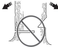
Amikor a döntőhajk és a döntővágás elkészült, a fának saját súlyától, vagy pedig a döntőkeket vagy a döntőemelő segítségével el kell dőlnie.
