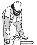
**VŠIMNITE SI!** Šnúru štartéra nevyťahujte naplno a nepúšťajte držadlo štartéra pri plnom vytiahnutí šnúry. Môže to poškodiť stroj.
