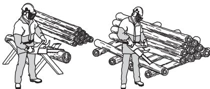
**Kmen leží na zemi.** Nehrozí příliš velké nebezpečí sevření řetězu a zlomení kmene. Hrozí však nebezpečí, že se řetěz dotkne země při dokončování řezu.
