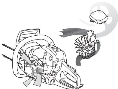
**DÔLEŽITÉ!** Aby systém odstredivého čistenia dobre fungoval, treba ho pravidelne udržiavať. Vyčistíte vstup pre prívod vzduchu do štartovacieho zariadenia, rebrá zotrvačníka, priestor okolo zotrvačníka, saciu rúru a priestor karburátora.
