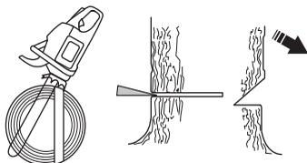
Dokončete hlavní řez rovnoběžně s hranou směrového zářezu, ale tak, aby mezi nimi zůstal nadořez o tloušťce alespoň 1/10 průměru kmene. Tento nadořez kmene bývá označován jako dřevorubecský kloub.
