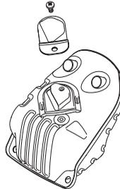
Tlmič výfuku je navrhnutý na znižovanie hladiny hluku a na smerovanie výfukových plynov preč od obsluhy. Výfukové plyny sú horúce a môžu obsahovať iskry, ktoré, ak sú namierené proti suchému a horľavému materiálu, môžu spôsobiť požiar.
