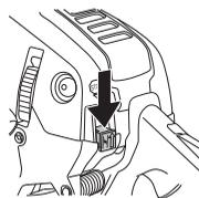
**VŠIMNITE SI!** Spínač spustenia/zastavenia sa automaticky vráti do polohy chodu. Aby ste zabránili nechcenému spusteniu, musí byť viečko kábla zapalovacej sviečky zo zapalovacej sviečky vždy odstránené, keď je stroj bez dozoru.
