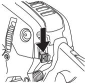
**VŠIMNITE SI!** Spínač spustenia/zastavenia sa automaticky vráti do polohy chodu. Pre zamedzenie neúmyselného spustenia musí byť viečko kábla zapalovacej sviečky pri montáži, kontrole a/alebo vykonávaní údržby zo zapalovacej sviečky odstránené.
