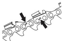
W celu ustalenia stopnia zużycia łańcucha zalecamy porównanie go z całkiem nowym łańcuchem.
