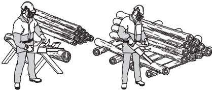
**A rönk a talajon nyugszik.** A láncszorulás vagy a tönk szétrepedésének veszélye kicsi. Fennáll ellenben annak a veszélye, hogy a lánc a vágás befejezésekor hozzáér a talajhoz.
