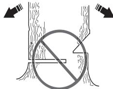
Po dokončení směrového zářezu a hlavního řezu by se strom měl začít kácet samovolně nebo pomocí dřevorubecského klínu či páčidla.
