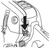
**UPOZORNĚNÍ!** Spínač spuštění/zastavení se automaticky vrátí do polohy běhu. Pro zamezení neúmyslného spuštění musí být koncovka kabelu zapalovací svíčky při montáži, kontrole a/nebo provádění údržby ze zapalovací svíčky odstraněna.
