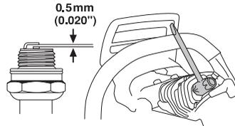
**Poznámka!** Vždy používajte odporúčaný typ zapaľovacej sviečky! Nesprávna zapaľovacia sviečka môže vážne poškodiť piest/valec. Skontrolujte, či je zapaľovacia sviečka správne nasadená.
