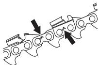
Výrobce doporučuje porovnávat stávající řetěz s novým řetězem a tak zjistit, jak je stávající řetěz opotřebený.
