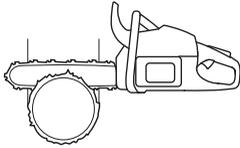
Vannak módszerek a vágószerkezet hosszánál nagyobb átmérőjű fák kivágására is. Ezek a módszerek azonban jóval nagyobb kockázatot jelentenek, mivel a vágószerkezet visszarugási zónája érintkezik a fával.
