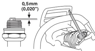
Pamatujte si! Vždy používejte doporučený typ zapalovacích svíček! Použití jiného typu zapalovacích svíček by mohlo poškodit píst či válec. Dbejte na to, aby svíčka měla tzv. radiové odrušení.
