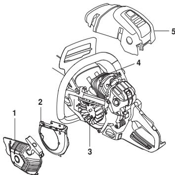
Tisztítsa meg kefével a hűtőrendszert hetente egyszer, erős igénybevétel esetén gyakrabban is. Szennyezett vagy eltömődött hűtőrendszernek a gép túlmelegedése az eredménye, ami a dugattyú és a henger károsodását okozza.
