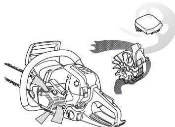
**FONTOS!** A centrifugális tisztítás működőképességének megőrzéséhez folyamatos karbantartásra és tisztításra van szükség. Tisztítsa meg az indítókészülék levegőnyílásait, a lendkerék ventilátorlemezait, a lendkerék környékét, a beszívócsatornát és a porlasztót.
