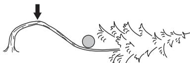
Rozhodněte, jaký je nejbezpečnější způsob uvolnění napětí a zda je možné to provést bezpečně. Ve složitých situacích je jedinou bezpečnou metodou odložit pilu a použít naviják.
