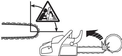
A vágószerszemet alsó részével történő vágást, azaz a felülről lefelé történő vágást húzó vágásnak nevezzük. Ebben az esetben a motorfűrész a fa irányába húzza önmagát, és vágás közben a motorfűrésztest elülső része természetes támaszkodási pontot képez. A húzó irányú vágás jobb ellenőrzést biztosít a motorfűrész és a visszarúgási zóna felett.
