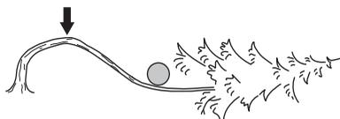
Premyslite si najbezpečnejší spôsob uvoľnenia pnutia a zväžte, či to dokážete bezpečne urobiť. V komplikovaných prípadoch je jedinou bezpečnou metódou odložiť reťazovú pílu a použiť navijak.
