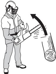
Odbicie powstaje wyłącznie w momencie zetknięcia się strefy odbicia prowadnicy z twardym przedmiotem.
