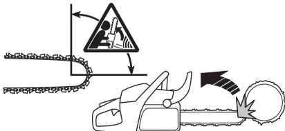
Řezání spodní stranou lišty, tzn. shora dolů, se označuje jako řezání nabíhacím řetězem. V tomto případě řetěz přitahuje pilu směrem ke stromu a přední část těla pily se při řezání bezprostředně opírá o kmen. Řezání nabíhacím řetězem poskytuje uživateli lepší kontrolu nad motorovou pilou a polohou oblasti zpětného rázu.
