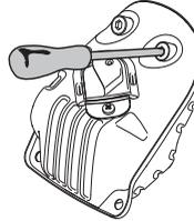
Některé tlumiče výfuku jsou vybaveny speciálním sítkovým lapačem jisker. Pokud vaše zařízení je opatřeno takovým typem tlumiče výfuku, měli byste jeho sítko čistit alespoň jednou za týden. Toto sítko vyčistíte nejlépe ocelovým kartáčem. Ucpaná sítko způsobí přehřátí motoru a může vést k vážnému poškození.
