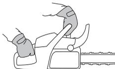
Wciśnij dźwignię gazu do oporu i włącz hamulec łańcucha obracając nadgarstek lewej ręki w kierunku zabezpieczenia przed odbiciem. Nie zdejmuj dłoni z uchwytu przedniego. **Łańcuch powinien zatrzymać się natychmiast.**
