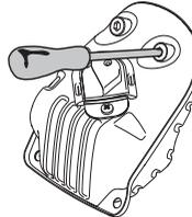
Bizonyos kipufogódobok speciális szikrafogó hálóval vannak ellátva. Ha az Ön gépén van ilyen háló, akkor azt hetente legalább egyszer meg kell tisztítania. Ezt drótkéfével lehet a legjobban elvégezni. Ha eltömődött a szikrafogó háló, a motor túlmelegedhet, és ez súlyos károsodáshoz vezethet.
