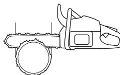
I pro kácení stromů o průměru větším než je délka lišty existují určité metody. Tyto metody však představují mnohem větší bezpečí kontaktu oblasti zpětného rázu lišty se stromem.
