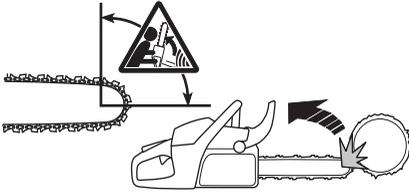
Praca dolną krawędzią prowadnicy, tzn. podczas cięcia przedmiotu od góry, jest czasem określana jako praca przy ciągnącym ruchu łańcucha. W tym przypadku następuje przyciąganie pilarki w kierunku ciętego drewna, przy czym przednia krawędź korpusu pilarki stanowi dla jej naturalne oparcie w stosunku do kłody. Praca dolną krawędzią prowadnicy ułatwia użytkownikowi kontrolę nad pilarką i położeniem strefy odbicia prowadnicy.
