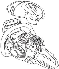
Dokładniejsze czyszczenie filtra wymaga wymycia go w wodzie z mydłem.
