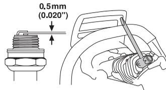
Zauważ! Stosuj wyłącznie świece zalecane przez producenta. Niewłaściwa świeca może być przyczyną zatarcia tłoka/cylindra. Dopolnij, aby świeca zapłonowa była wyposażona w tzw. eliminator zakłóceń radiowych.
