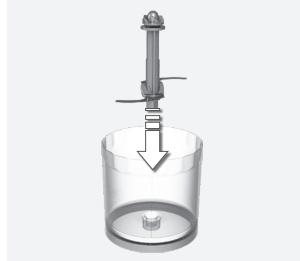
**FR** 4. **Utilisation du mini-hachoir\*.** Placer le hachoir sur une surface propre et plane. Mettre le couteau en acier inoxydable en place.
