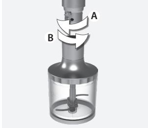
6. **Insérer le bloc moteur dans le couvercle du hachoir** et le faire pivoter dans le sens des aiguilles d'une montre (A) jusqu'à ce qu'il s'enclenche. Brancher l'appareil à la prise de courant et appuyer sur l'interrupteur pour le mettre en marche. Relâcher le bouton pour l'arrêter. Retirer la partie poignée en la faisant pivoter dans le sens inverse des aiguilles d'une montre (B).
