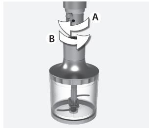
6. **Włóz rękojeść do pokrywy siekacza** i obróć ją w kierunku zgodnym z ruchem wskazówek zegara (A), aż do zatrzaśnięcia. Podłącz zasilanie i naciśnij włłącznik. Puść wyłącznik, aby przerwać. Odlacz rękojeść, przekręcając ją w kierunku przeciwnym do ruchu wskazówek zegara (B).
