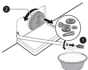
**4** Po vyčistení filtra odtokového čerpadla filter opatrne vložte späť a odtokový uzáver opatrne zaskrutkujte späť v smere hodinových ručičiek, aby ste predišli nesprávnemu zakrúteniu a netesnosti. Uzáver zasuňte späť do odtokovej hadice a hadicu vložte do držiaka.
