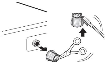
filtr odtokového čerpadla **2** a vypusťte zbývající vodu a poté odstraňte z filtru veškeré nečistoty nebo předměty.
