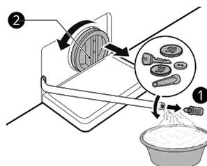
**4** Po vyčistení filtra odtokového čerpadla vyberte filter odtokového čerpadla a vložte zátku odtokovej hadičky.
