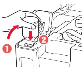
**6** Delikatnie wyjmij butelkę z atramentem z wlotu.
