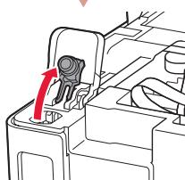
**3** Tartsa függőlegesen a tintatankot, és óvatosan csavarja le a flakon sapkáját.
