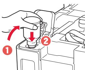
**6** Láhev na inkoust opatrně vyjměte z přívodu.
