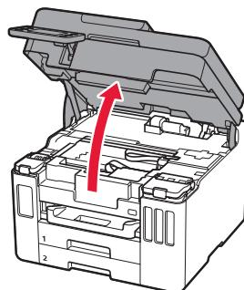
**2** A nyomtató bal oldalán nyissa ki a tintatartályfedelet és a tartálysapkát.
