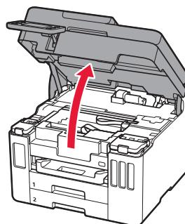
**2** Odprite pokrov črnilnega vložka in pokrovček vložka na levi strani tiskalnika.
