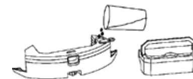
Tanque de agua eléctrico
