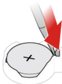
Obrázek 120. Stisknutí kovové západky pomocí šroubováku
