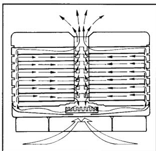
Sacími otvory v základní jednotce se nasává vzduch, ohřívá se na teplotu nastavenou elektronickým termostatem a soustavou rozváděcích kanálků na obvodu síť se vhání do vnitřního prostoru jednotlivých sít. Středovým otvorem síť a víka je část vzduchu vytlačována ze sušičky, část vzduchu se nasává zpět, dohřívá se a vhání znova do prostoru sít.
