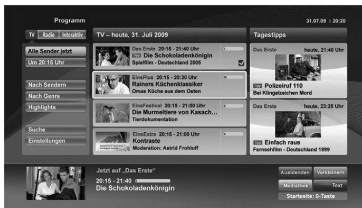
Obrázek b: EPG aplikace, vysílané video je ukázáno v levém spodním rohu, spuštěno pomocí 0.
