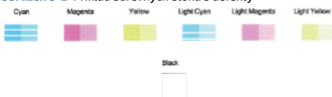
Obrázek 9-2 Příklad barevných bloků s defekty
