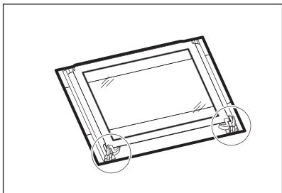
5. Uvolněte blokovací systém a vytáhněte vnitřní skleněný panel.
