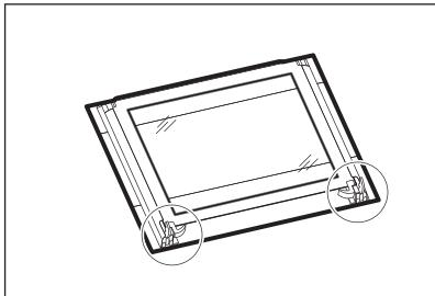
5. Uvoľnite blokovací systém a vyberte vnútorný sklenený panel.
