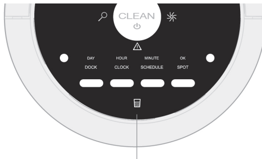
Светлинен индикатор за пълен контейнер
