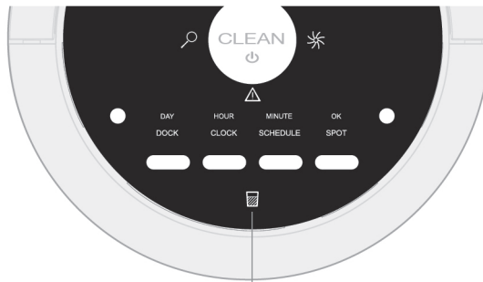
Tartály telítettség kijelző
