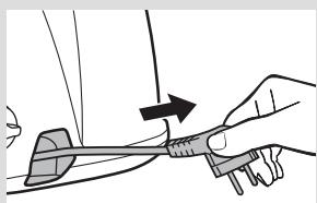
**3** Uložte parní hadici (6) a síťový kabel (7) do navíjecího systému (8).
