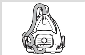
**2** Umístěte žehličku na parní stanici tak, že ji postavíte na podložku (12). Jestliže je vaše parní stanice vybavena systémem fixace žehličky (13\*), upevněte žehličku do tohoto systému. Nejprve vložte spodní stranu žehličky a poté páku držáku posuňte proti hraně žehličky.
