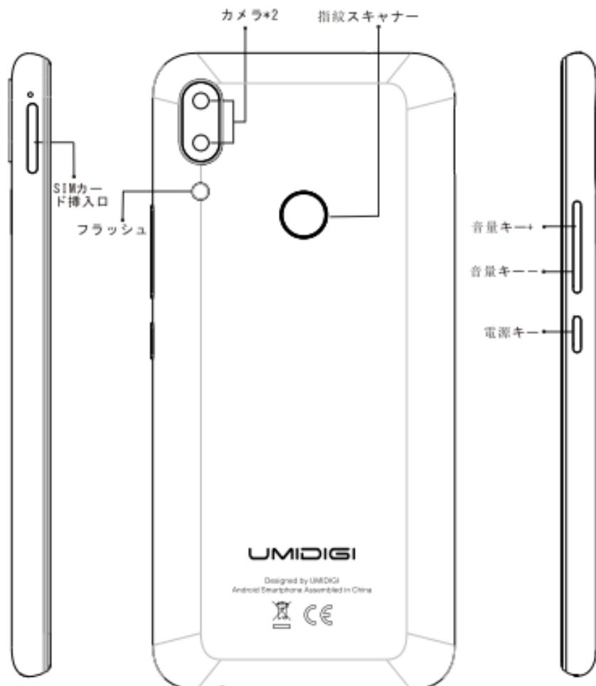
音量キー: 短く押すと音量を調節または着信をミュートします。
