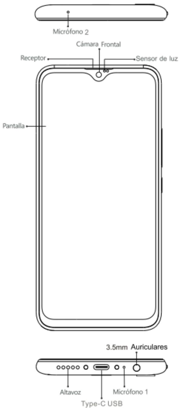
**Botón de encendido:** Pulse el botón de forma prolongada para activar el terminal. Mediante pulsación corta podrá encender y apagar la pantalla.
