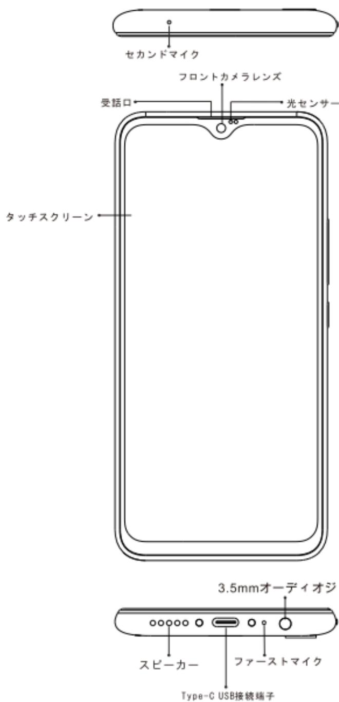
電源キー:長押しすると本端末がオンになります。本端末がオンの時は、電源キーを短く押すと画面をシャットダウンまたはオンにします。
