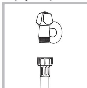
1. Pripojte prívodnú hadicu jej zaskrutkováním ku kohútiku so studenou vodou s hrdom so závitom 3/4" (viď obrázok). Pred pripojením hadice nechajte vodu odtieciť, až kým nebudete číra.
