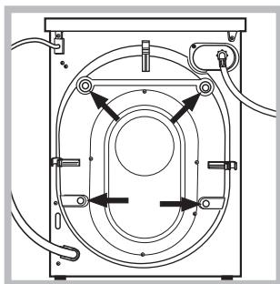
3. Csavarozza ki a gép hátsó részén található, a szál-lításhoz szükséges 4 védőcsavart, és távolítsa el a gumi-bakot (lásd ábra).
