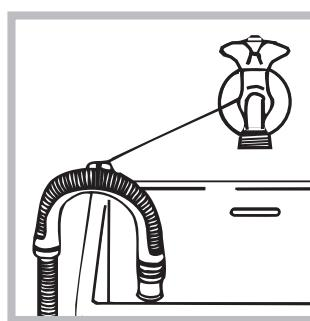
свързвайки доставения водач към крана (вж. фигуранта). Свободният край на маркуча за мръсната вода не трябва да бъде потопен във водата.
