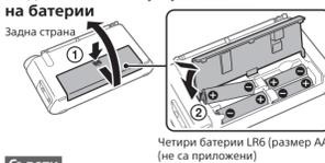
За да използвате устройството на заряд от батериите, извадете конектора на адаптера за променливотоково захранване от жака DC IN. Устройството не може да се захранва с батерии, ако конекторът на адаптера за променлив ток е включен в DC IN жак.
