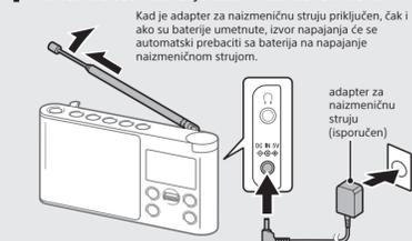
Kad je adapter za naizmjeničnu struju priključen, čak i ako su baterije umetnute, izvor napajanja će se automatski prebaciti sa baterija na napajanje naizmjeničnom strujom.
