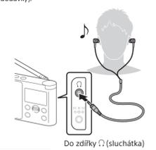
**Poznámka:** Při připojování sluchátek k přístroji použijte sluchátka se stereofooním (3pólovým) nebo monofooním (2pólovým) minikonkterem. Pokud použijete sluchátka s jiným typem konektoru, může vzniknout rušivý šum nebo nemusí být slyšet žádný zvuk.
