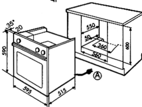
Dbajte o to, aby sa prívodný kábel nedotýkal vrchnej steny rúry.
