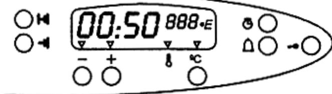
Teraz je rúra naprogramovaná. V tomto prípade 50 min. pred nastaveným časom vypnutia 14.30 hod. bude rúra zapnutá a automaticky sa vypne v nastavenom čase, t. j. 14.30 hod. a súčasne sa zapne ALARM. Pre vypnutie ALARMU použite tlačidlo .
