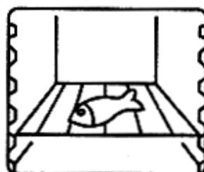
Stiskněte tlačítko zapnuto/vypnuto ①. Tlačítkem F nastavte funkci rozmrazování ②. Teplota je automaticky nastavena na 75°C. Tuto teplotu můžete regulovat po 5°C směrem dolů max. na 50°C. Po rozmrazení potraviny vypněte troubu tlačítkem ①.
