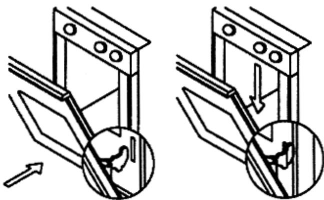
Otvorte dvierka do krajnej polohy a otočte závoru do jej pôvodnej polohy. Teraz sú dvierka nasadené späť.
