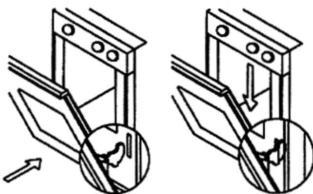
Otevřete dvířka do krajní polohy a otočte závorou do její původní polohy. Nyní jsou dvířka nasazena zpět.
