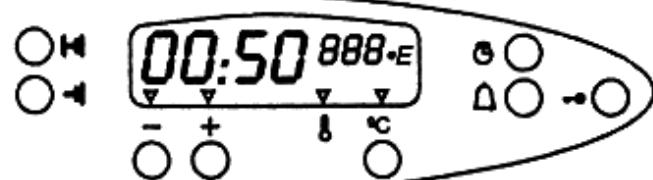
Nyní je trouba naprogramována. V tomto případě 50 min. před nastaveným časem vypnutí 14.30 bude trouba zapnuta a automaticky se vypne v nastavený čas, tj. 14.30 a současně se zapne ALARM. Po vypnutí ALARMU použijte tlačítko .
