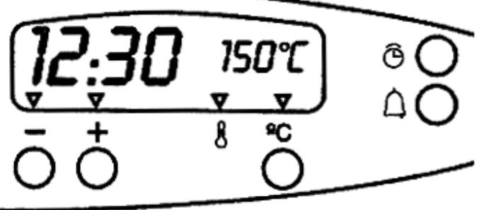
Napríklad: 150°C (viz. tab.). Rúra sa zapne počas nie- koľkých sekúnd. Pre ukončenie pečenie stlačte tlačidlo ①. Pa- mätajte na to, že rúra pracuje bez použitia časového spínača a preto ju musíte vypnúť ručne.
