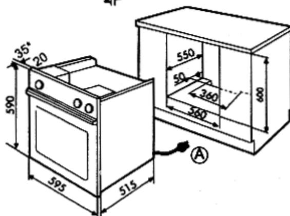
Dbejte, aby se přívodní kabel nedotýkal vrchní stěny trouby.
