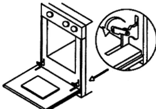
Pomalu přivírejte dvířka až ucítíte odpor. Pak je uchopte oběma rukama a vytáhněte je při současném přivírání až jsou závěsy venku z drážky. Nyní jsou dvířka vyjmutá.
