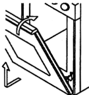
Při zpětném nasazování dvířek nasadte závěsy do drážek jak je uvedeno na obrázcích.
